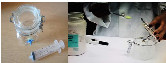
Figura 19. Frasco que cierra herméticamente y jeringa de 60 mL. A la derecha, en el momento de poner en su interior una pequeña cantidad de azufre
