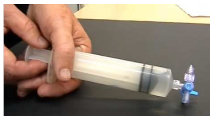
Figura 8. Al estirar el émbolo, el agua hierve a muy baja presión
