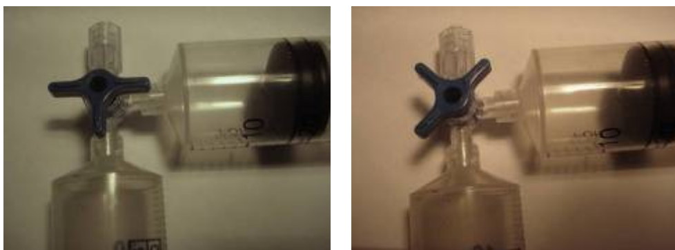
A l'esquerra: la clau connecta les dues xeringues. A la dreta: la clau tanca el pas de les dues xeringues alhora.
