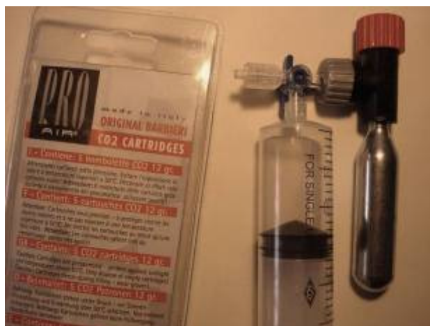
Manera d'omplir una xeringa amb diòxid de carboni
