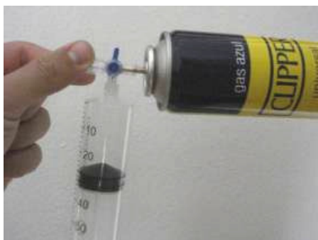
Manera d'omplir una xeringa amb gas butà
